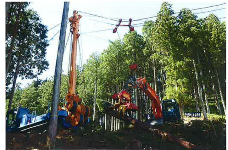
タワーヤーダが全木集材し、これをハーベスタが掴んで造材する。
